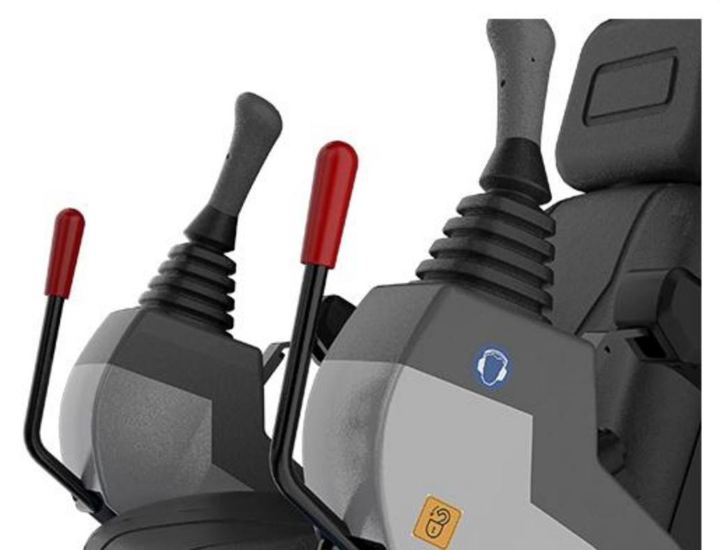
**2 Leva di blocco del funzionamento**
